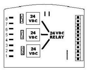
24VDC RELAYS MUST BE INSTALLED FOR 24VDC SYSTEM OPERATION
