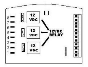
12VDC RELAYS MUST BE INSTALLED FOR 12VDC SYSTEM OPERATION
